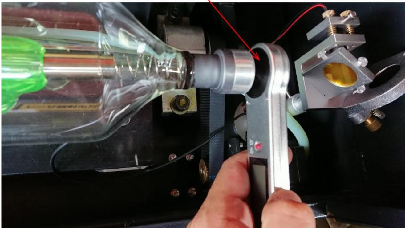
レーザー出力計の測定部はできるだけ、機体、パーツに接触しないようにしてください。
