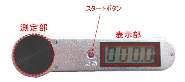
スタートボタンを押して、表示部の液晶が表示されることを確認して下さい。表示は 20 秒程度で自動的に消灯 します。
