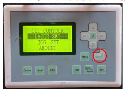
4. 「LASER SET」が表示されたら、「LASER TIME SET」が 00000 [ms]、「POWER SET」が 100 [%]の設定になっていることを確認します。
