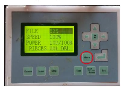
2. メニュー画面な遷移したら、↓ ボタンを押下して、「LASER SET」にカーソルを移動します。
