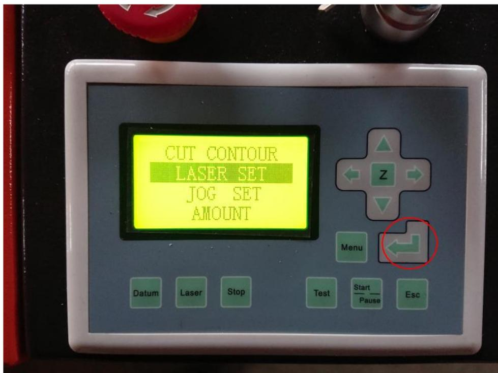
4. 「LASER SET」が表示されたら、「LASER TIME SET」を前述②で確認した時間を設定します。「LASER TIME SET」の単位は[ms]ですので。レーザー出力計記載の値を 1000 倍して設定します。16sec のレーザー出力計の設定値は 16000、32sec のレーザー出力計の設定値は、32000 になります。
