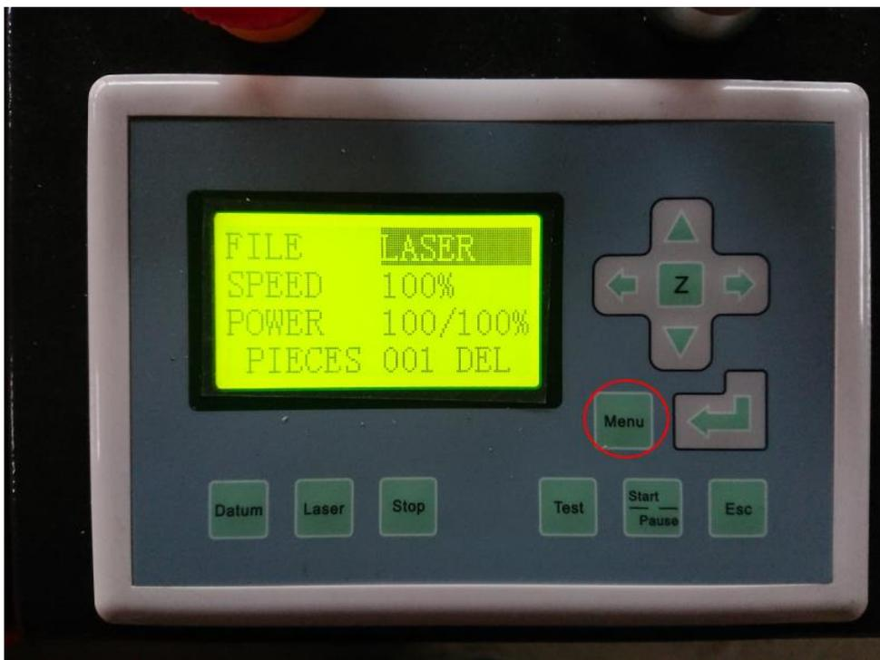
2. メニュー画面へ遷移したら、↓ ボタンを押下して、「LASER SET」にカーソルを移動します。
