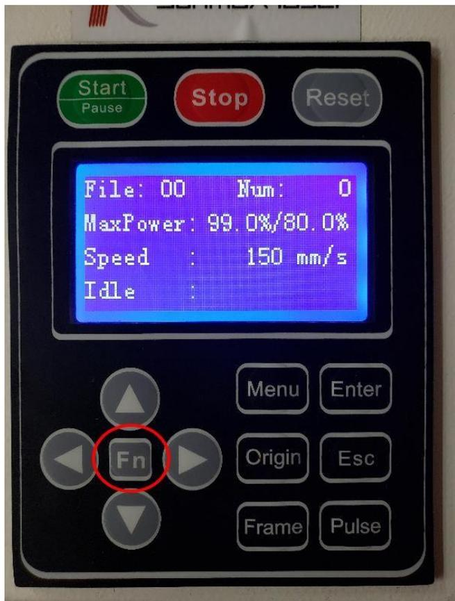
Fn メニューが表示されたら、↓ボタンを3回押下して、「Laser Set」にカーソルを合わせます。カーソルを「Laser Set」に移動させたら、Enter ボタンを押下します。
