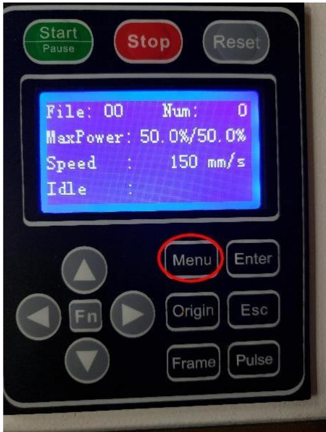
Menu 画面が表示されたら、下矢印ボタンを2回押し、カーソルを「Max Power」に移動させます。カーソルが「Max Power」にある状態で、Enter ボタンを押下します。
