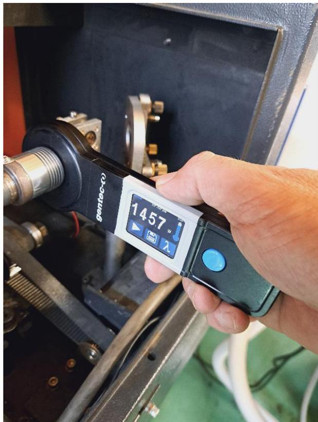
カウントダウン開始後、5秒経過すると、レーザー出力値(〇〇〇 w)が表示されます。
