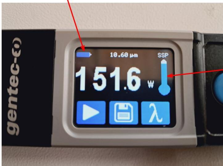
バッテリー残量表示は、レーザー出力計のバッテリー残量を表します、バッテリー残量が少ない場合は、付属のUSBケーブルを使用して充電してください。
