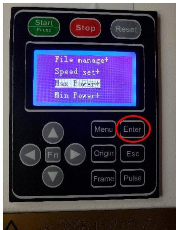
Max Power1 にカーソルがある状態で、Enter ボタンを押下してカーソルを数値設定部分に移動させます。
