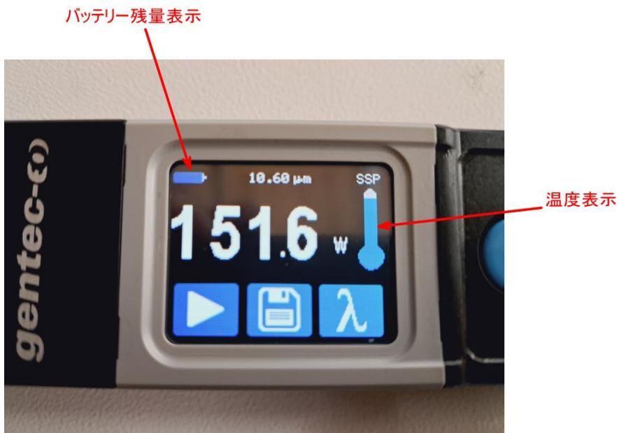
バッテリー残量表示は、レーザー出力計のバッテリー残量を表します、バッテリー残量が少ない場合は、付属のUSBケーブルを使用して充電してください。
