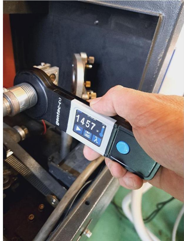
カウントダウン開始後、5秒経過すると、レーザー出力値(○○○ W)が表示されます。
