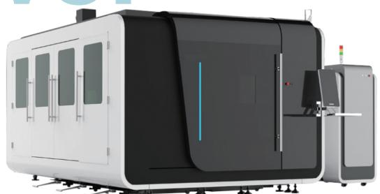
FL3015LNなどのミディアムパワータイプは十分なワークエリアと、使いやすさを重視したファイバーレーザー切断機です。カスタマイズもしやすく、幅広いアイテムの製造に利用されています。また、FL3015Pは、ミディアムタイプを保護カバーで覆うように設計されており、安全性を重視した仕様です。
