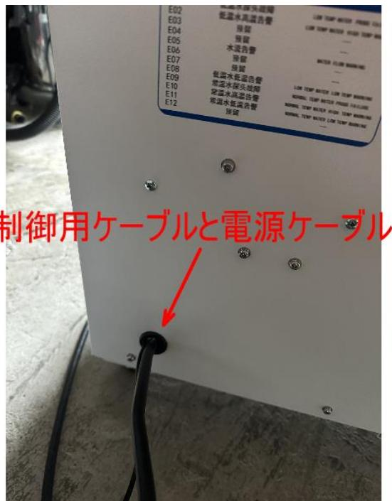
制御用ケーブルは 2 本線で端子は下図のようになっています(電源ケーブルは 3 本線)。
