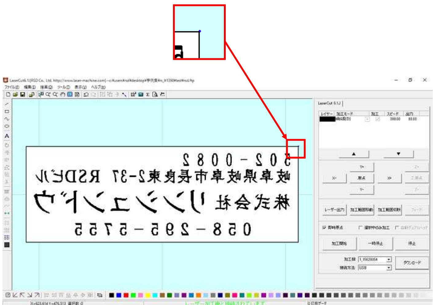
加工原点は、標準ツールバーのレーザー原点ボタンをクリックすることにより可能です。
