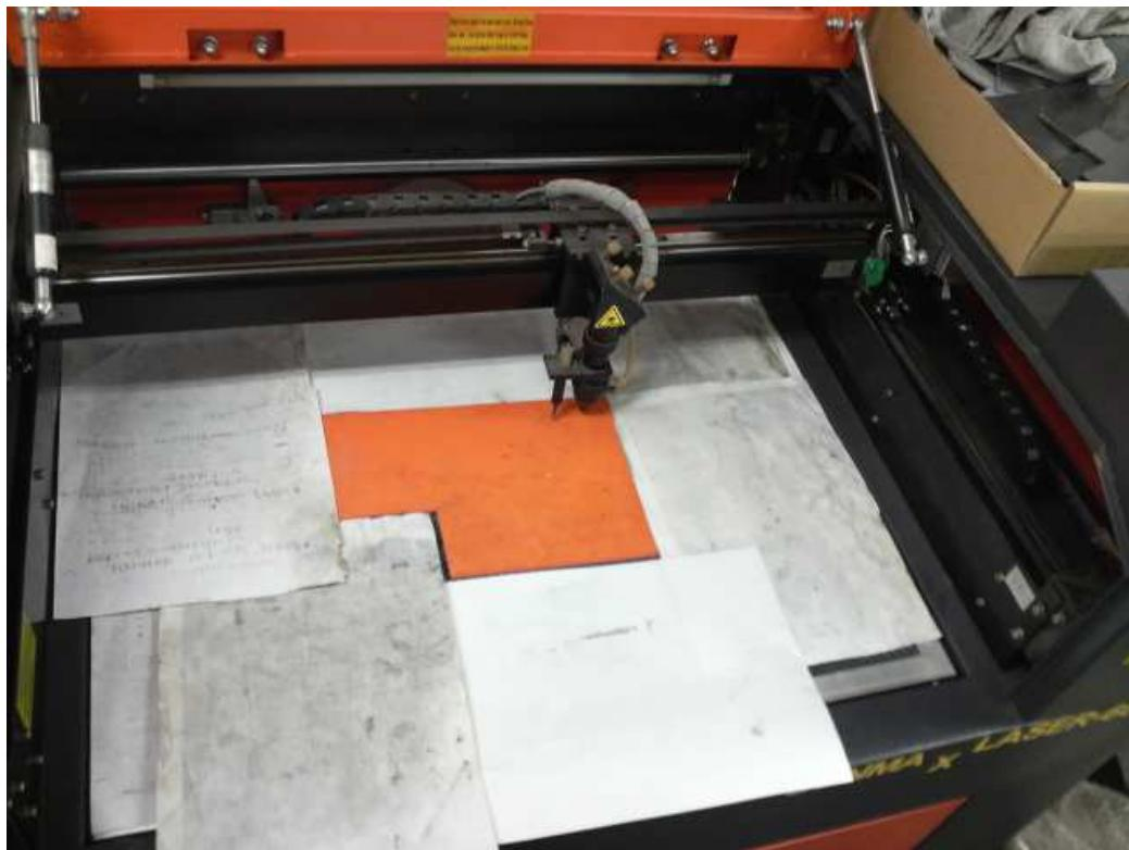
データの右上を加工原点に設定していますので、ゴムの右奥の位置にレーザーヘッドが来るようにします。
