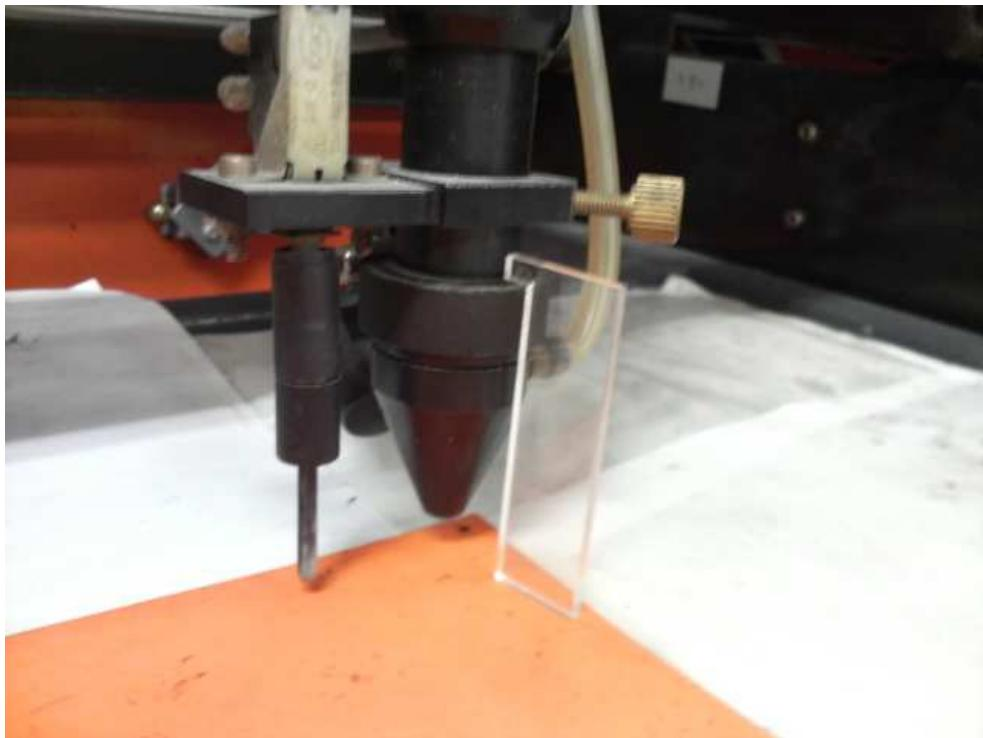
3. レーザー加工機のコントロールパネルにあるテストボタン
