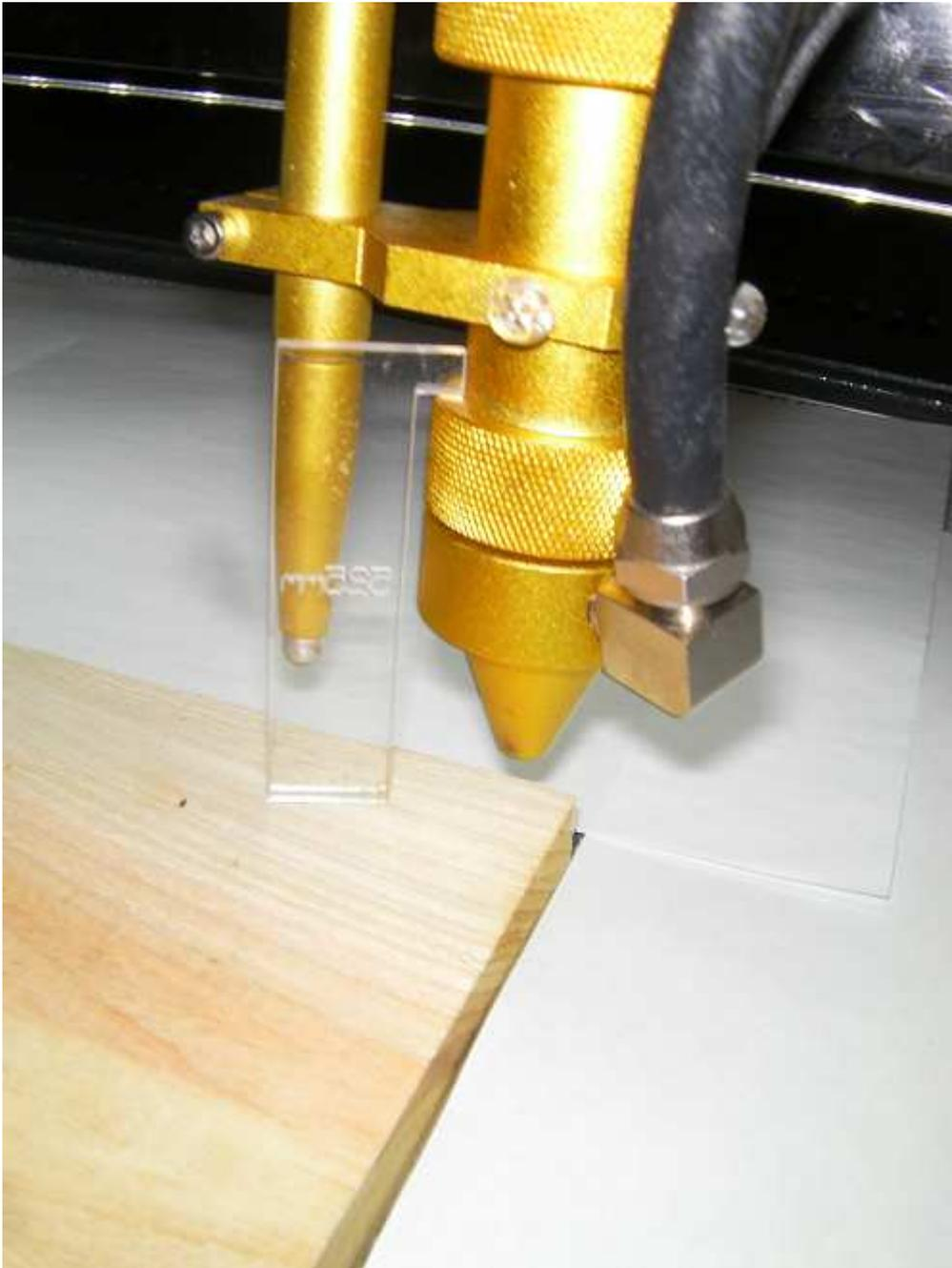
3. レーザー加工機のコントロールパネルにあるテストボタン
