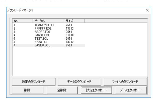
※ ダウンロードマネージャには、レーザー加工機に保存されている加工データの一覧が表示されます。上図例では、7件のデータが保存されていることがわかります。保存データがない場合は、何も表示されません。表示内容は、レーザー加工機の状況により異なります。
