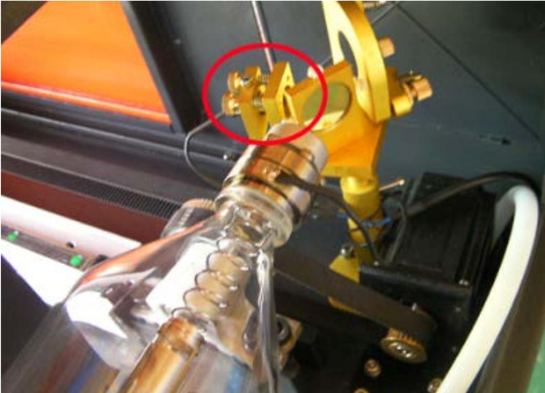
照射スポットを調節ネジで調節しても位置が合わない、赤色光が拡散してしまっているなどの問題が起きた場合に今回説明する光質の調整を行います。
