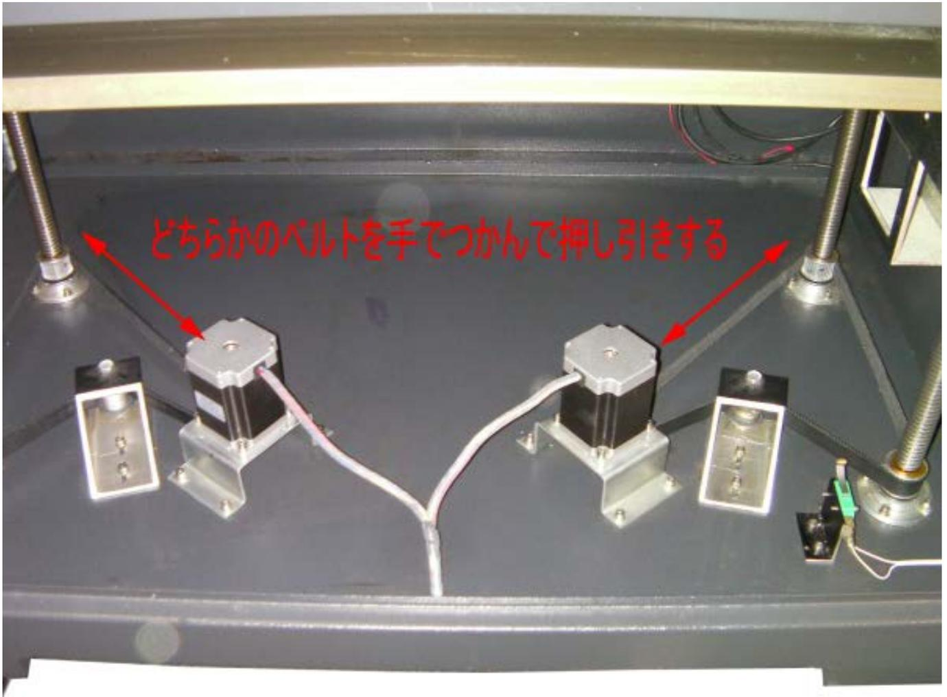
機種、ロットによってレイアウトが異なり、また手でつかむベルトの位置によって、押し引きのよる上下動の挙動が変わります。はじめに少しだけ押ししたり引いたりしながら、テーブルの挙動を確認してください。
