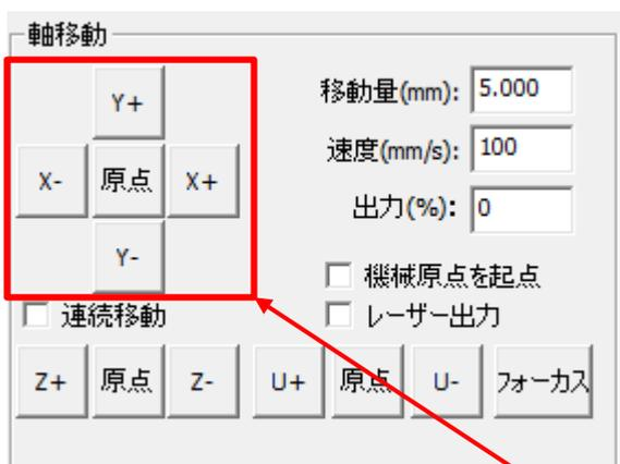
「Y+」をマウスで押下すると、レーザーヘッドは奥方向へ移動します。
