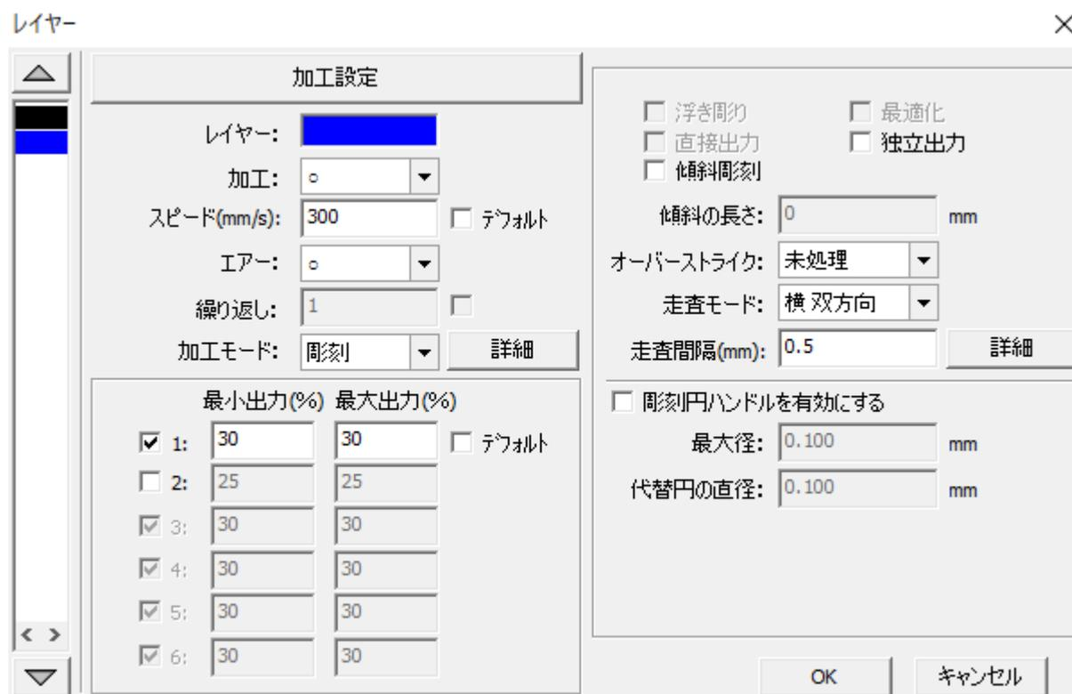
「デフォルト」にチェックを入れると、スピード、最小/最大出力の設定は無効になります。チェックが入っている場合は、操作パネルの Speed set/Min Power/Max Power の設定速度で加工します。
