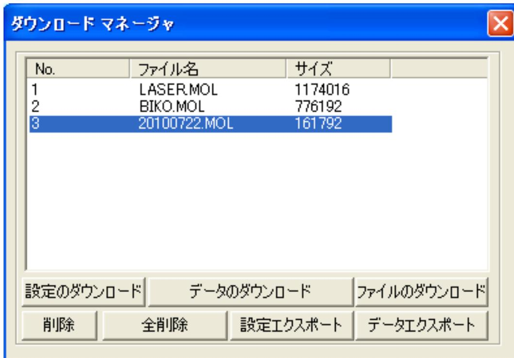
※ ダウンロードマネージャには、レーザー加工機に保存されている加工データの一覧が表示されます。上図例では、3つのデータが保存されていることがわかります。保存データがない場合は、何も表示されません。表示内容は、レーザー加工機の状況により異なります。
