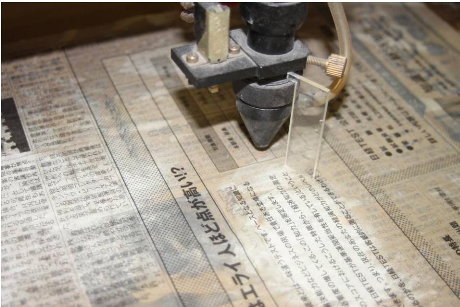
3. レーザー加工機のコントロールパネルにあるテストボタン
