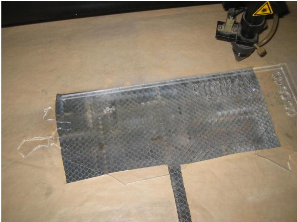
データの右上を加工原点に設定していますので、素材の右奥の位置にレーザーヘッドが来るようにします。
