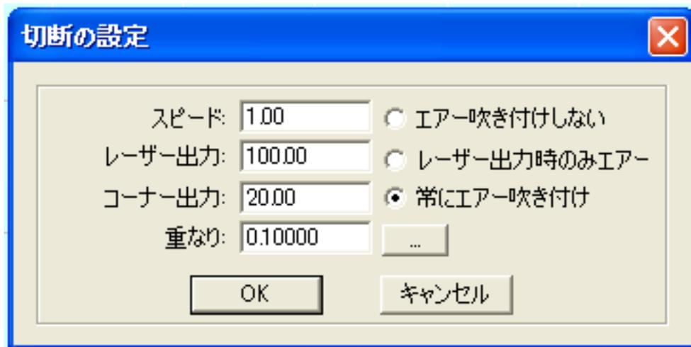
アクリルの厚さ、要求品質にあわせて、「スピード」、「レーザー出力」、「コーナー出力」の値を設定してください。
