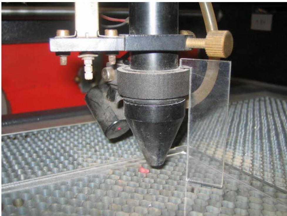
焦点ゲージの位置とずれていた場合は、手動で自動昇降テーブルを上下させ、適切な位置に合わせてください。
