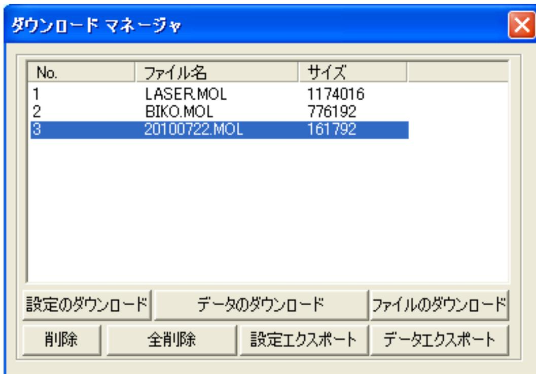
※ ダウンロードマネージャには、レーザー加工機に保存されている加工データの一覧が表示されます。上図例では、3つのデータが保存されていることがわかります。保存データがない場合は、何も表示されません。表示内容は、レーザー加工機の状態により異なります。
