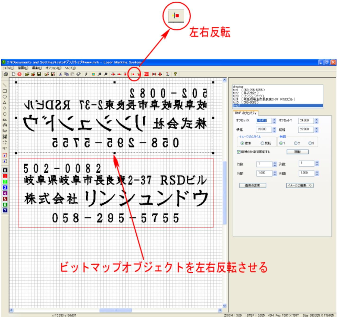
④ 全てのテキストオブジェクトを全選択して、スキヤニングエリア(赤枠)の外に移動させます
