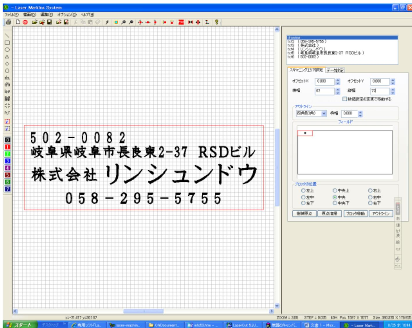
※ スキニングエリア(赤枠)は実際の印面サイズより縦横 2mm 程度大きくしておきます。H60 x H20 の住所印の場合は、横幅 62mm、盾幅 22mm に設定します。
