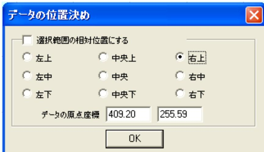
左上～右下のラジオボタンをクリックすることにより、レーザー原点位置(青色ドット)の位置が変更します。
