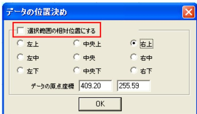
例として(Ax-Q)を選択した状態(下図赤色)で、「右上」に設定すると、レーザー原点位置がデータ全体の右上の位置ではなく、選択範囲の右上位置に移動します。
