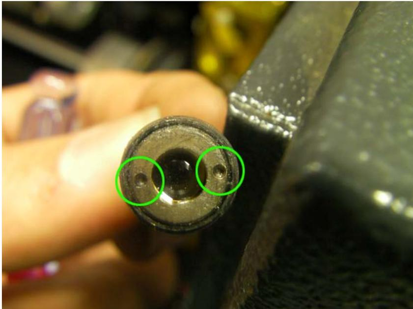
この穴を時計回り、反時計回りに、円を描くように回す事によって、光質を調整する事が出来ます。穴は小さいので細くて尖っている物を用意して下さい。(ペンや工具など)今回はドライバーを使います。
