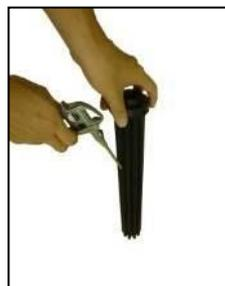
1 次フィルタ室から⑧までの手順を行い、1 次フィルタを 1 本 1 本抜き取ります。次に 1 次フィルタに付着した粉塵は、水洗いまたは、エアブローでメンテナンスして下さい。（水洗いの場合、よく乾かして下さい）
