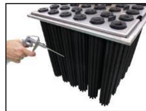
1 次フィルタ室から⑦までの手順を行い、フィルタ押さえ板とともに、1 次フィルタを抜き取り、フィルタが転倒しない様に床に置いて下さい。次に 1 次フィルタに付着した粉塵は、水洗いまたは、エアブローでメンテナンスして下さい。（水洗いの場合、よく乾かして下さい）
