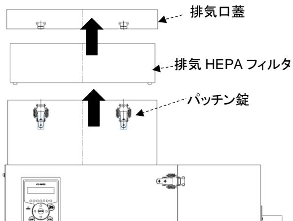
3. 新しい排気 HEPA フィルタを取り付けます。
