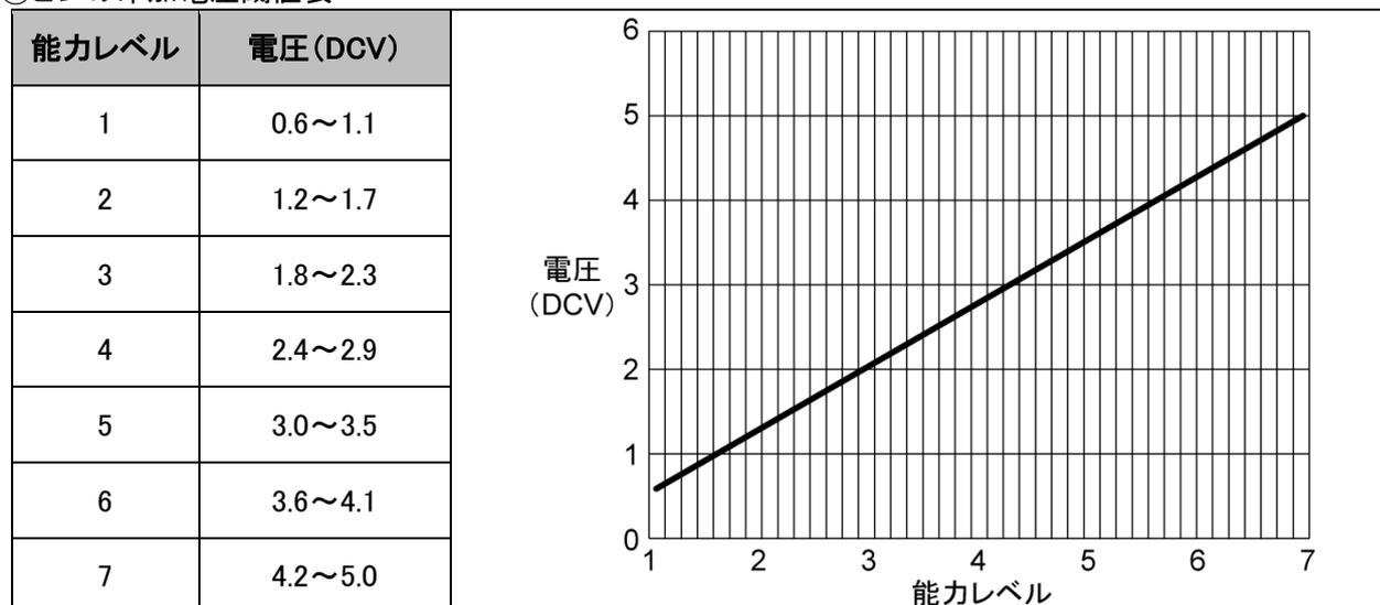
誤差が±4%あるため、電圧を設定する場合は、各レベルの中点の電圧を印加してください。
