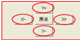
レーザーヘッドを移動させるには、それぞれの方向の4つのボタンを使用します
