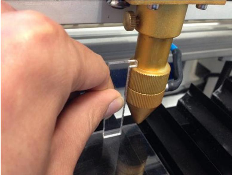
焦点ゲージを使用して手動で焦点合わせを行う
