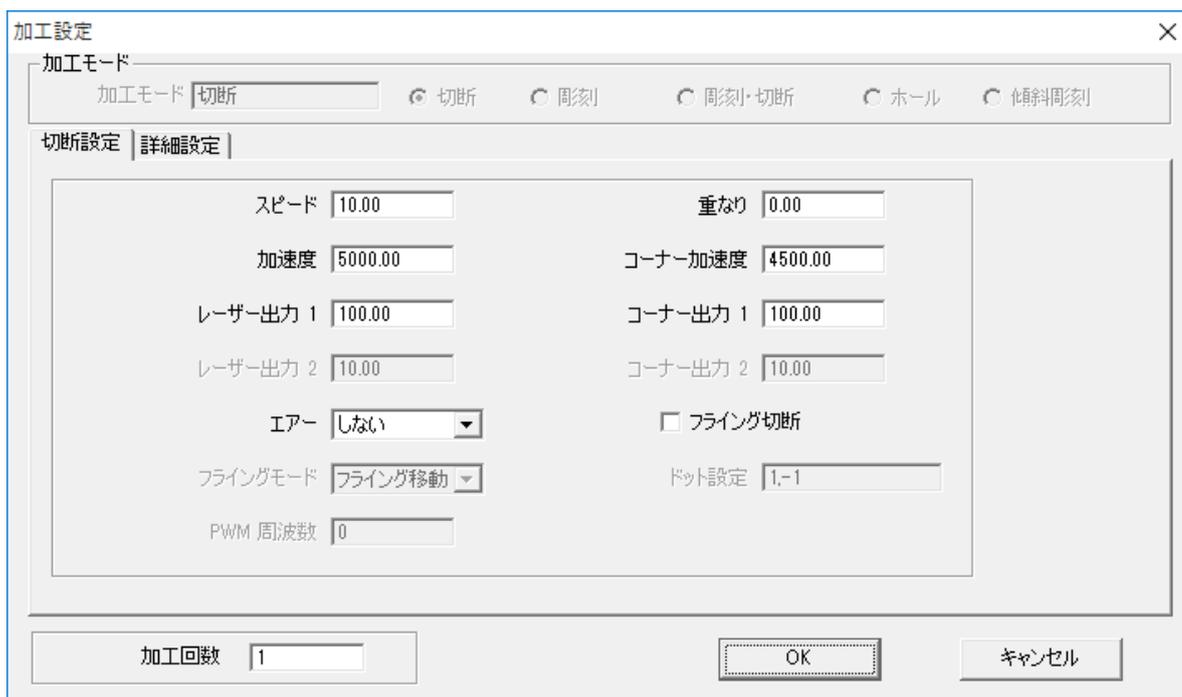
アクリルの厚さ、要求品質にあわせて、「スピード」、「レーザー出力1」、「コーナー出力1」の値を設定してください。
