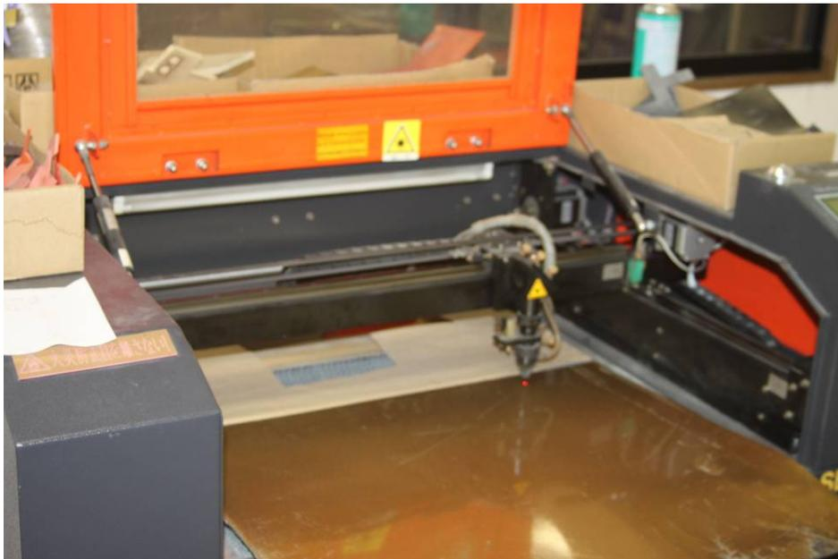
データの右上を加工原点に設定していますので、素材の右奥の位置にレーザーヘッドが来るようにします。
