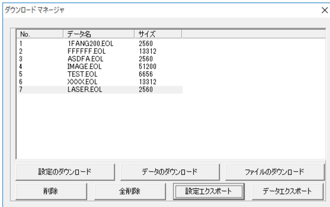
※ ダウンロードマネージャには、レーザー加工機に保存されている加工データの一覧が表示されます。上図例では、7件のデータが保存されていることがわかります。保存データがない場合は、何も表示されません。表示内容は、レーザー加工機の状態により異なります。
