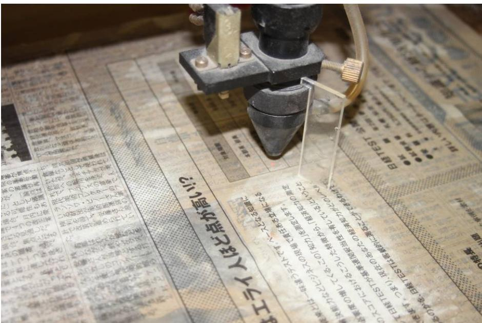
3. レーザー加工機のコントロールパネルにあるテストボタン
