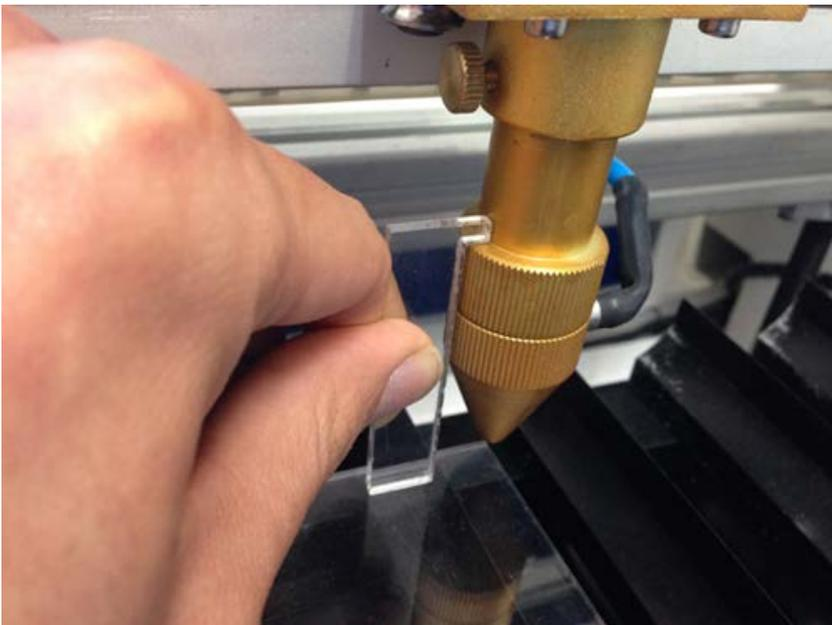
素材とテーブルの高さが合わなかった場合は、テーブル昇降ハンドルで昇降テーブルを上下させ、適切な位置に合わせてください。
