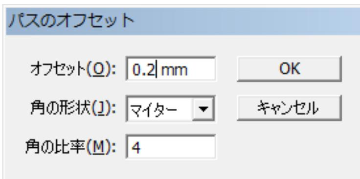
「オフセット」の値に太らせる幅を設定します。レーザー加工によって線が細くなるという現象を補正する用途では、通常、0.05～0.2 程度の値を設定します。
