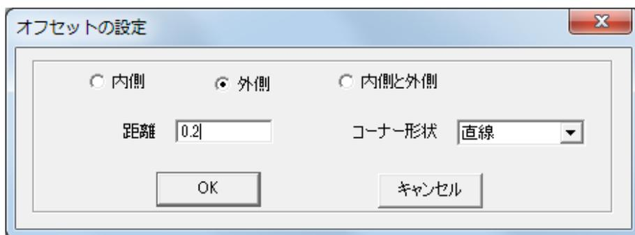
「距離」の値に太らせる幅を設定します。レーザー加工によって線が細くなるという現象を補正する用途では、通常、0.05～0.2程度の値を設定します。
