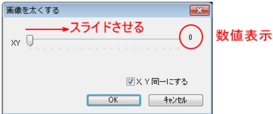
通常、レーザー加工によって線が細くなるという現象を補正する用途では、通常、2~8程度の値を設定します。
