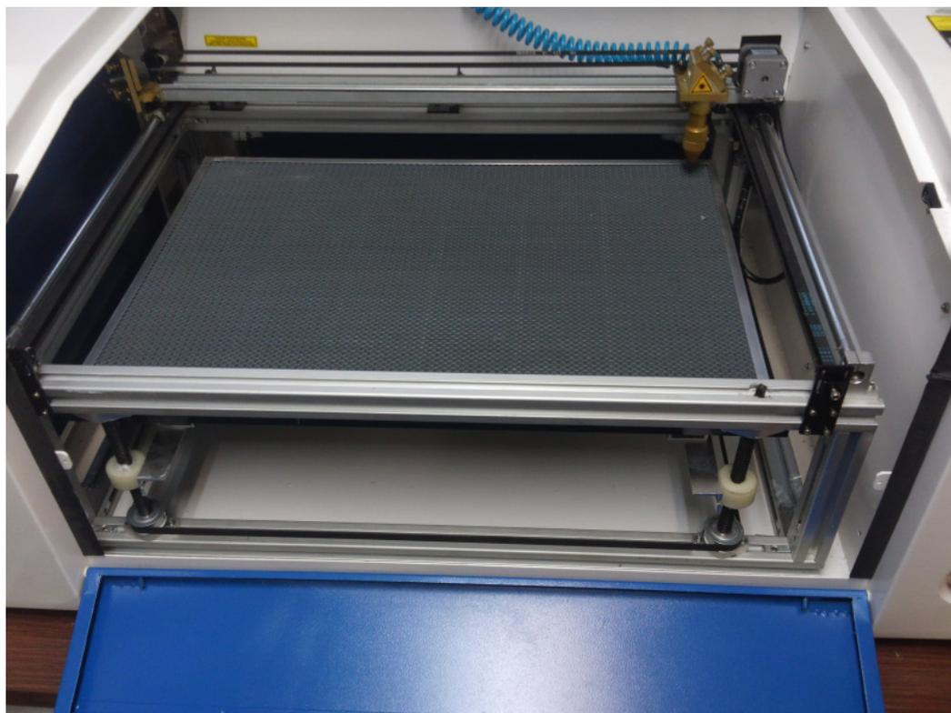
② 4本のボールネジにある、ジュラコンに固定されているステーのネジを緩めます。
