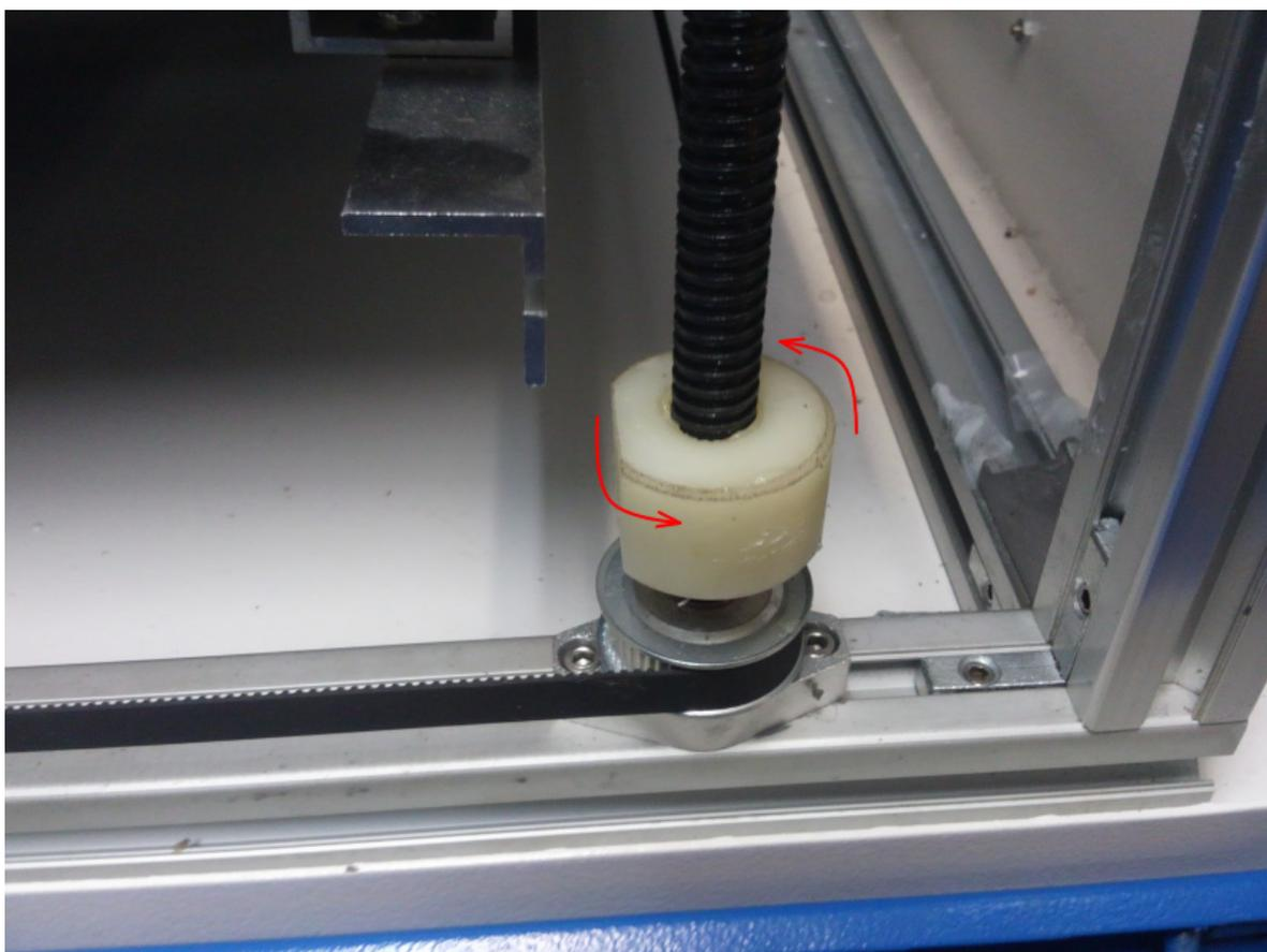
ねじ穴はひとつなので、ジュラコンは 360° 回転させる必要があります。ジュラコンが一回転すると、高さが約 3mm 変化します。
