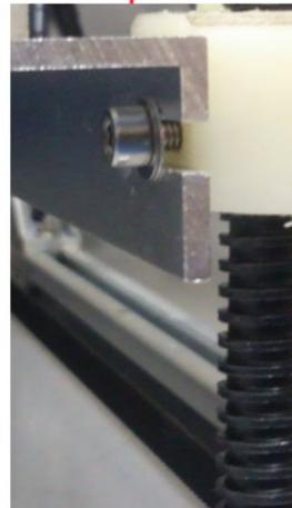
ステーのねじ穴はネジ径に対して数 mm の余裕がありますので、ステーの固定位置を変更を変更させて、高さを調整してください。
