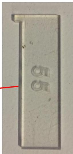
テーブル昇降ハンドルを使用して、焦点合わせゲージの底面が加工物と軽く擦れる程度まで高さを調節します。
