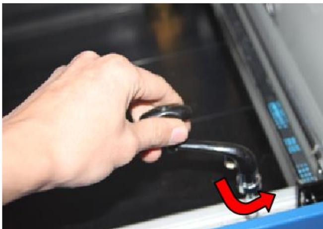
ハニカムテーブルが設置出来る程度のスペースを作る為、テーブル昇降ハンドルを使用します。反時計方向に回しZ軸を下げて下さい。
