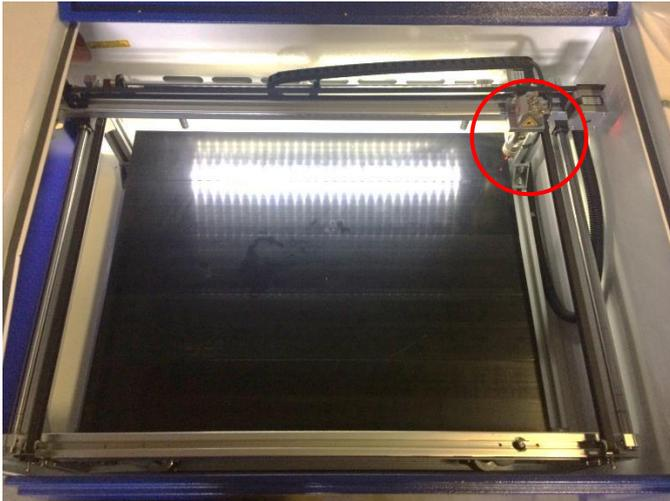
「開始」ボタンをクリックすると、レーザーヘッドは機械原点へと移動し加工を開始します。
