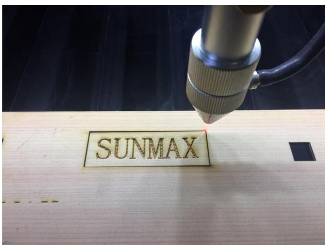
※ 論理原点の場合、「Origin」で原点を設定した後に、レーザーヘッドが他の位置へ移動した状態でも、加工を開始すると、レーザーヘッドは「Origin」で設定された論理原点へ移動し、加工を始めます。
