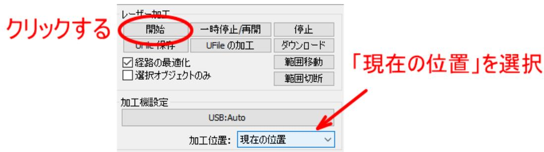
レーザー加工が開始されます。現在のレーザーヘッドの位置がデータ原点となります。
