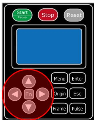
操作パネル方向キーを使いレーザーヘッドを移動できます。
