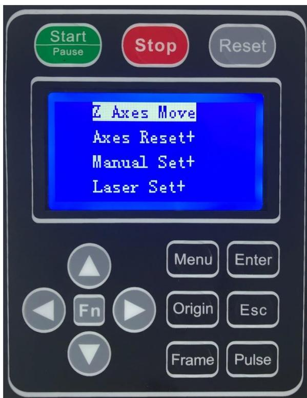
矢印ボタンを操作して、Laser Set+ に移動します。
