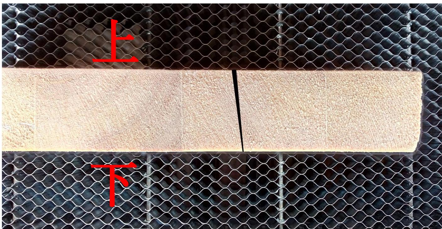
3次反射鏡の前の丸穴を通る位置を下方へずらしてください。
