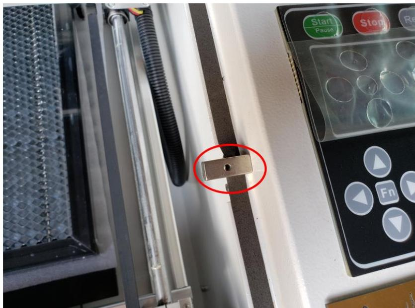
マグネットを置いたら、操作パネルの Pulse ボタンを押下して、レーザーが照射されるか確認します。
