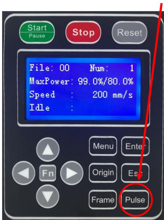
Pulse ボタンを押下すると、上面上扉が開いた状態でレーザー照射されるため、機体近辺の安全に注意を払ってください。
