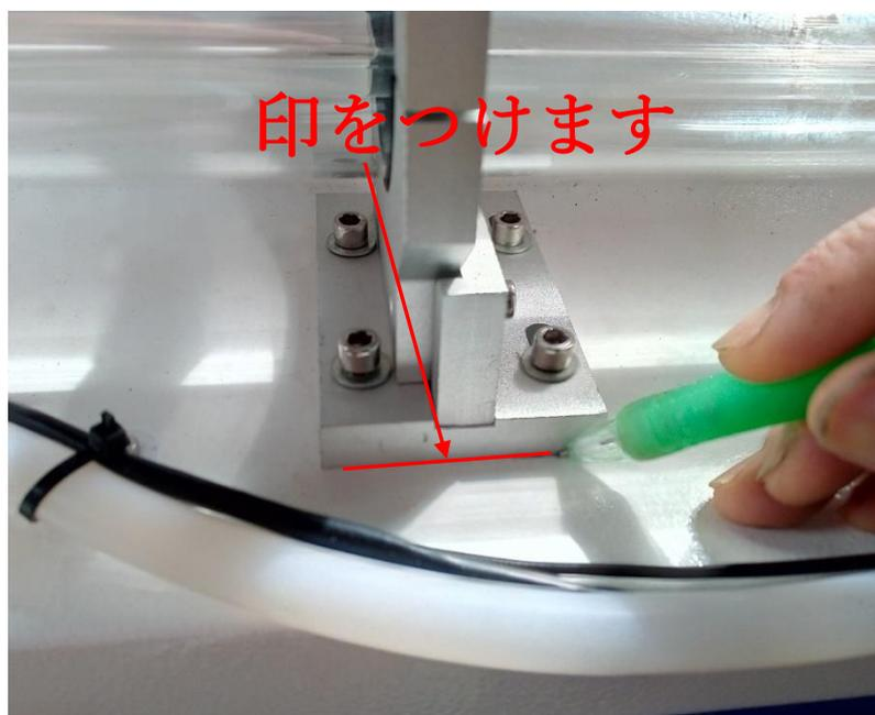
レーザー管は二つの取り付けベースで固定されています。一方の取り付けベースの左右だけを変えると、レーザー管が傾いている状態になり、光路調整が難しくなります。左右を変えるときは、必ず二つの取り付けベースの左右を変更してください。
