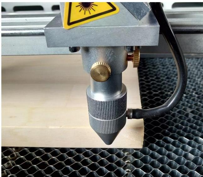
レーザー照射口の下から木板を奥側に移動させ、レーザー出力時でも木板に当たらないようにします。
