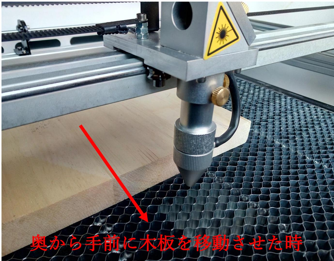
木板側面を正面から見て、レーザー光が下に行くにつれて右側へ傾いている場合。
