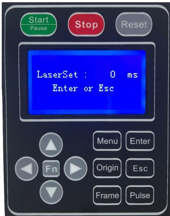
LaserSet の設定値は、矢印ボタンを使用して設定します。左右矢印ボタンで桁を移動させ、上下矢印ボタンで値を増減させます。
