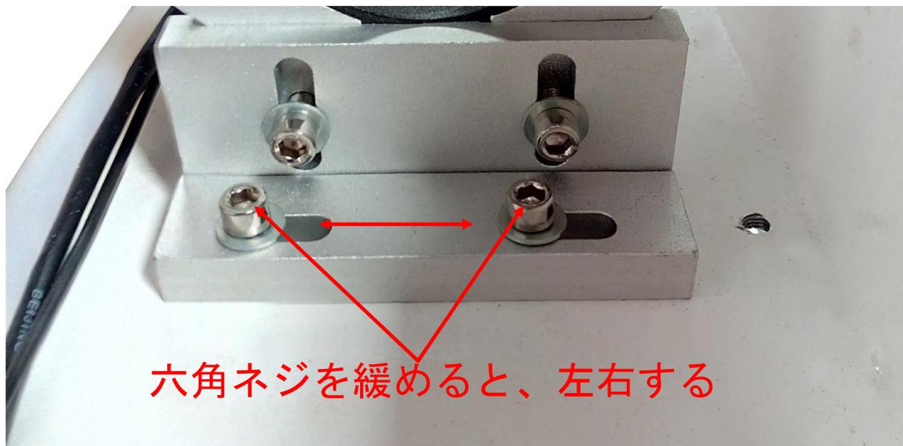
二つの取り付けベースをそれぞれ左右調整します。焦げ跡の位置と丸穴の中心の左右方向の距離だけ左右を変更します。
