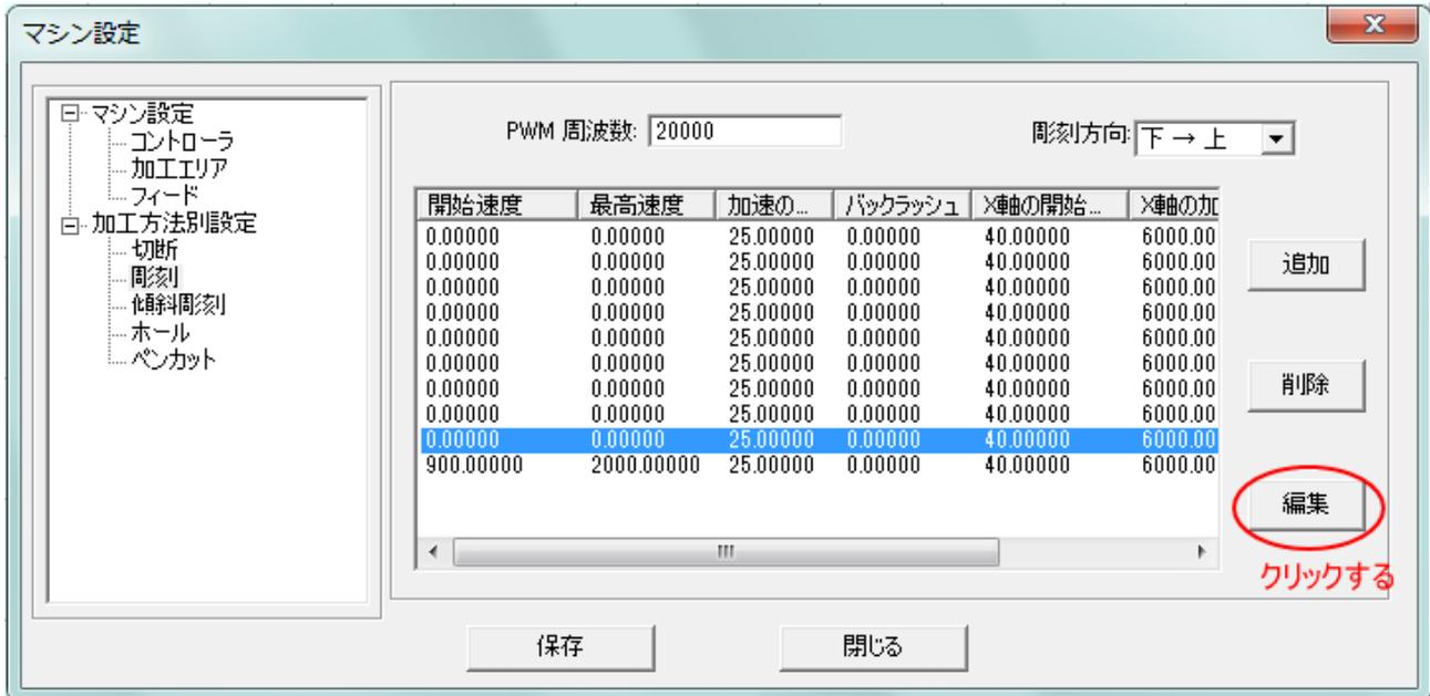
開始速度を 800、最高速度 900 に設定します。
