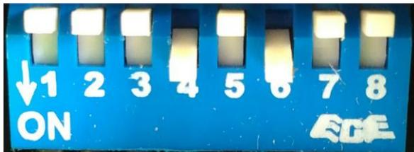
ステッピングモータ・ドライバのディップスイッチは8bits スイッチです。1~8 の数字が記載されている方に白いスイッチを倒すと ON になります。
