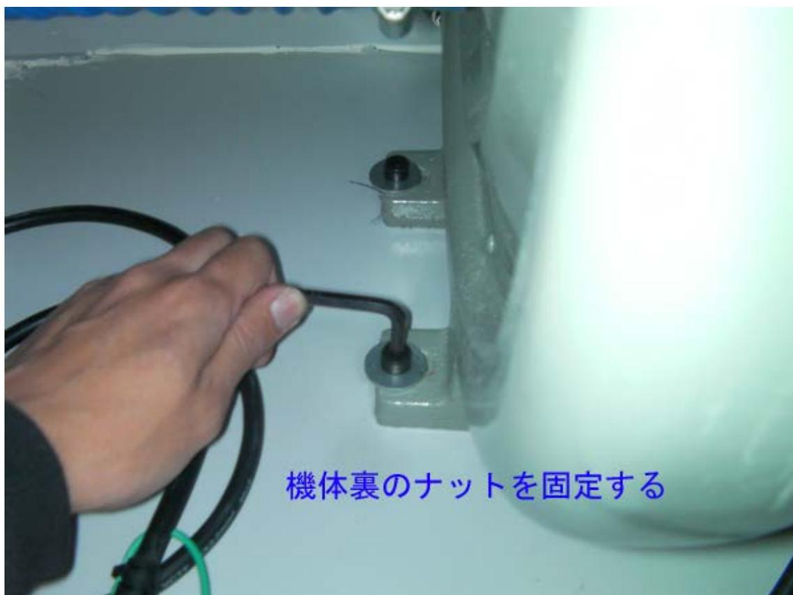
機体裏側にナットがあるので、工具で固定して、六角レンチなどを使用して取り外して下さい。
