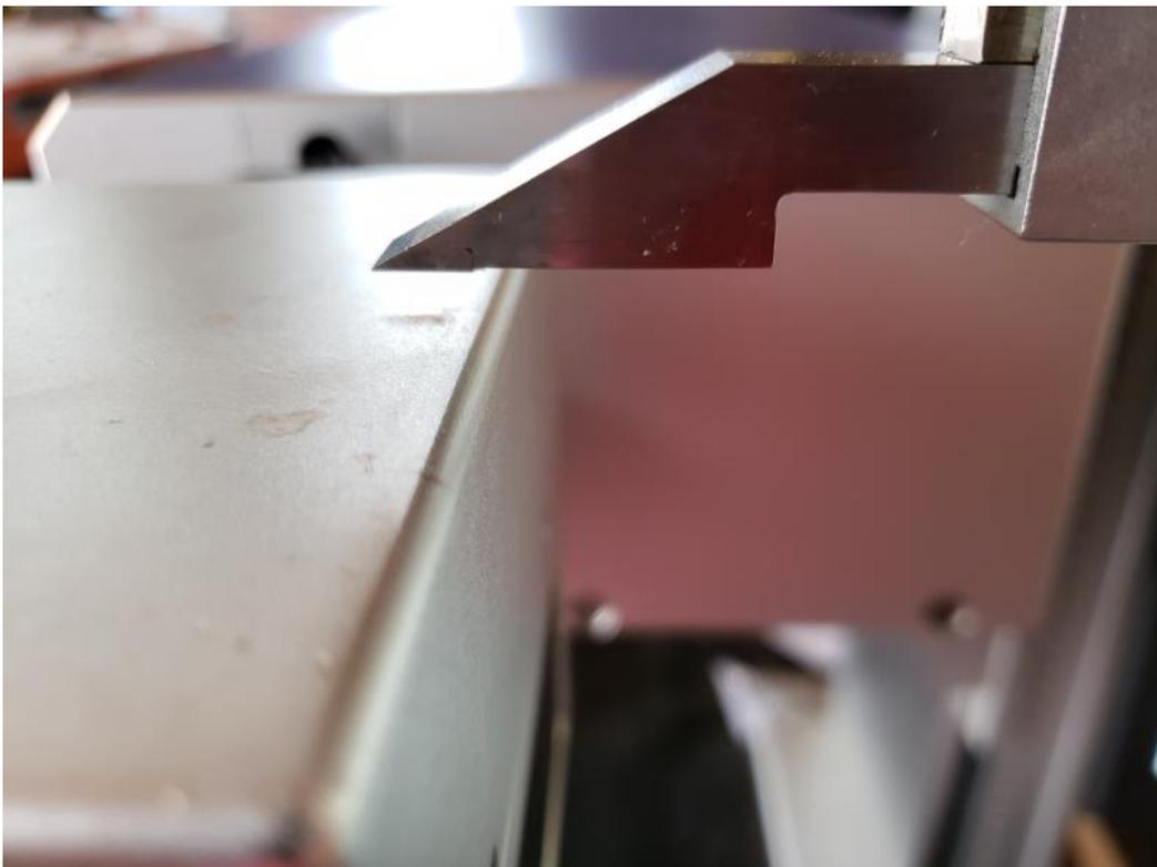
次に、機体の昇降ハンドルを操作して(時計回転方向に回して)、レーザーヘッドを上昇させます。慎重にゆっくりと回し、上昇させます。
