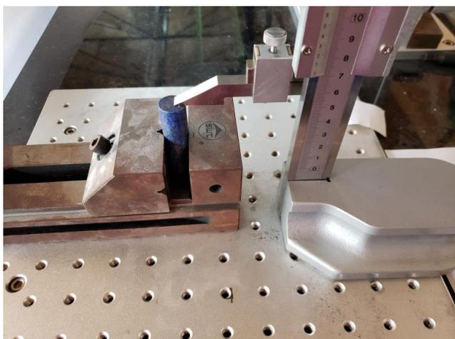
次に、印面の高さの測定値に「[焦点基準距離](#)」を加算した高さにスライダを移動させ、止めネジで固定します。
