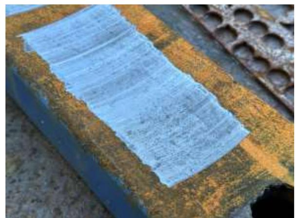
サビを完全に除去する為に2パス照射を行いました。①と異なり移動速度を遅くして照射を行った為、入熱が高くなっています。移動速度は40cm/sec程度になります。
