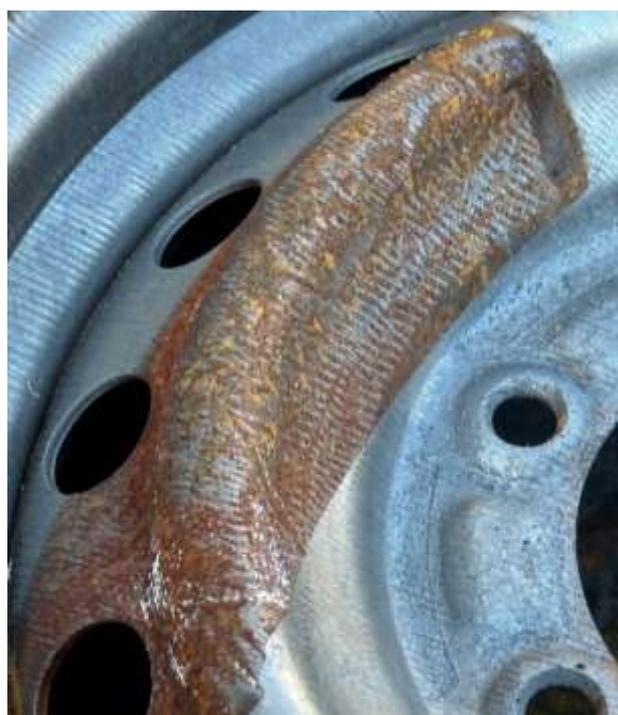
レーザーが強く当たった箇所はアルミ箇所が剥離してレーザーの跡が入っています。出力MAXの状態では3枚以上の重ねなどで対応すると良いです
